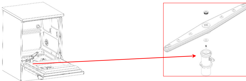
Rys. 14 — dolne ramię spryskujące: wymontować i wyczyścić, aby zapewnić skuteczne mycie.
